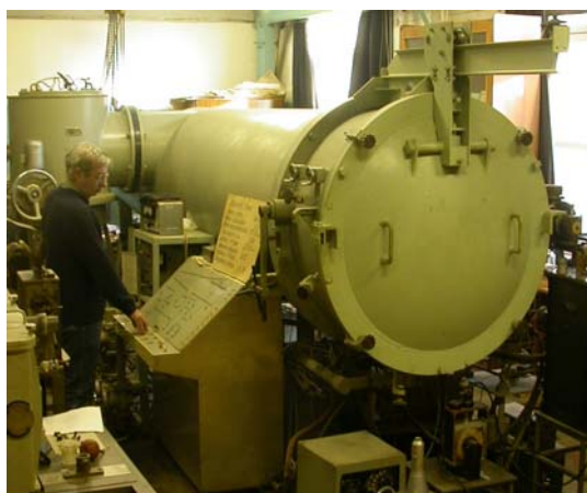
Рис.1. ВУФ-спектрограф высокого разрешения нормального падения излучения.
