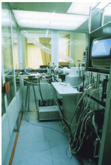
Рис.1. Аналитическая часть ЛАФАС-1, помещенная в чистый бокс.
