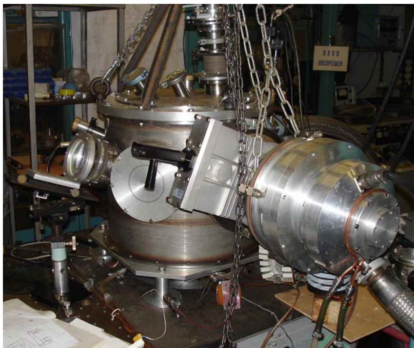
Рис 3. Прототип EUV источника с вращающимися электродами. Рабочие параметры: электрическая мощность – 18 кВт; \text{CE} \approx 2\% ; полезная мощность излучения \approx 360 Вт.
