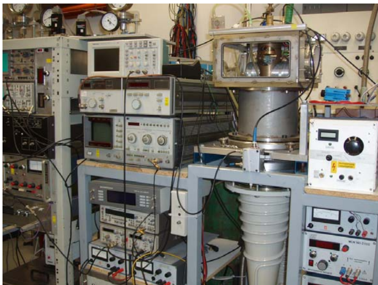
Рис. 1. Спектрометр высокого разрешения на базе оротрона для экспериментов с молекулярной струей.
