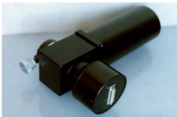
Малогабаритный спектрометр с ПЗС линейкой диапазона 200-1100 нм.
