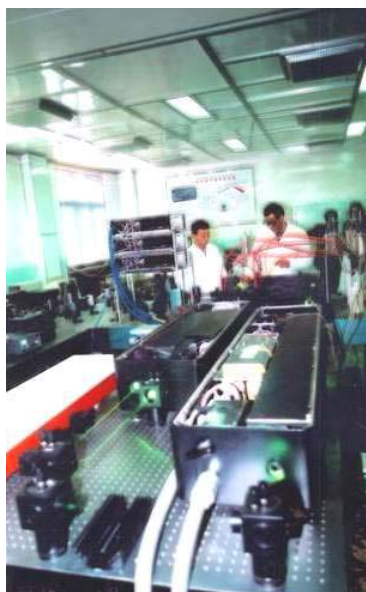
Рис. 1. Комплекс перестраиваемых лазеров для лазерной резонансной фотоионизации атомов.
