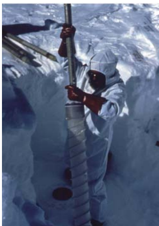
Рис. 4. Подъем керна льда на французской станции Dome C.
