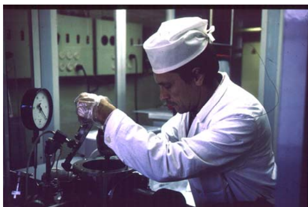
Рис. 2. Дозирование пробы в атомизатор.
