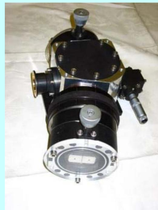
*ВУФ спектрометр скользящего падения излучения с временным разрешением*
