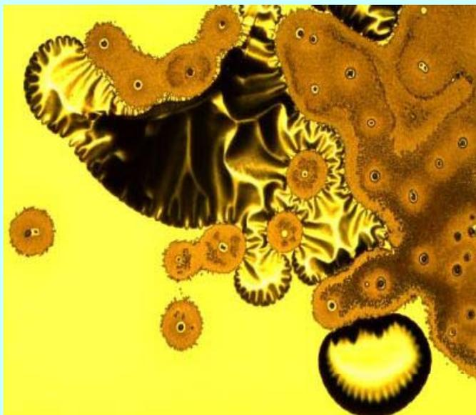
*Расслоение Mo/Si покрытия ВУФ облучением в водородной плазме*
