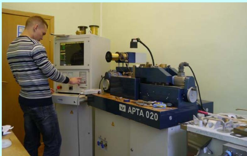
Электроэрозионный станок с ЧПУ для прецизионного изготовления сложных металлических деталей с допусками от 2 мкм (оператор инж. С.В. Орлов)
