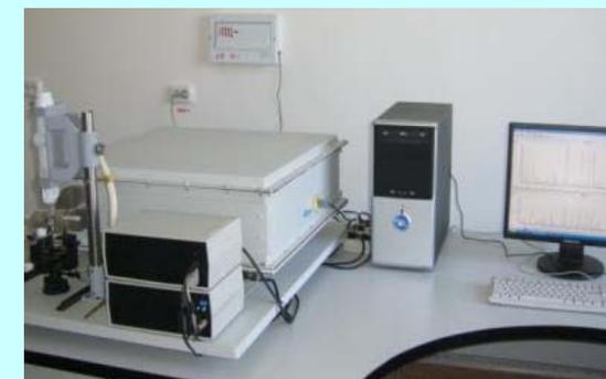
*Лазерно-искровой эмиссионный спектрометр с ФЭК на 24 ПЗС*
