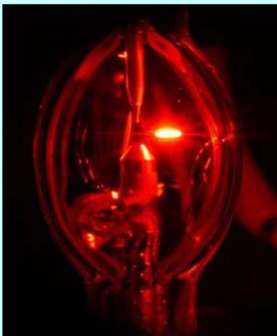
*Вид разряда, поджигаемого лазером в ксеноновой лампе высокого давления*
